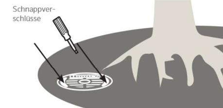
**Hinweis:** Verwenden Sie zur Wartung der RZWS Einheit ein Werkzeug, um auf die beiden Schnappverschlüsse zuzugreifen und die Kappe zu lösen (Abb. 4).
