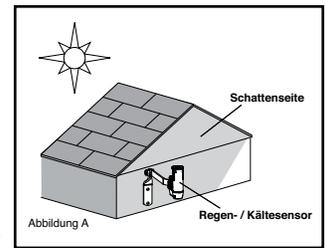
Dieser Zeitraum wird von der Position beeinflusst, in der der Sensor befestigt wird. Besondere Positionen, welche extreme Wettersituationen registrieren können, sind daher zu beachten. Wird der Rain-Clik z. Bsp. an der sonnigen Südseite eines Gebäudes angebracht kann er eventuell früher austrocknen als dies gewünscht wird. Andererseits kann die Befestigung an einer ständig im Schatten gelegenen Nordseite eines Gebäudes dazu führen, dass der Rain-Clik nicht rechtzeitig trocken wird.
