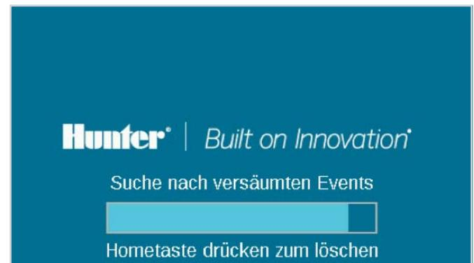
Diese Suche kann während der Installation oder Wartung eines Steuergeräts abgebrochen werden, indem Sie die „Start“ Taste auf der Bedienfront drücken.
