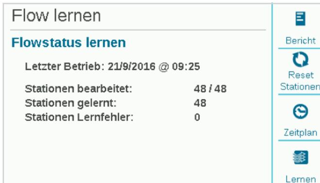
**„Flow lernen“ beendet alle weiteren Berechnungen, automatisch und manuell, bis der Lernvorgang abgeschlossen ist.** Ein Flow kann nicht gelernt werden, während andere Stationen aus anderen Gründen in Betrieb sind.
