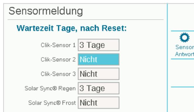
**Regenverzögerung:** Drücken Sie im Menü „Sensorreaktion“ den Soft-Key für „Regenverzögerung“. Diese optionale Einstellung sorgt dafür, dass die Beregnung für eine bestimmte Anzahl an Tagen verzögert wird, nachdem die Sensoraktivierung beendet wurde. Wählen Sie für jeden Clik-Sensor Eingang die Anzahl an Tagen, die die Beregnung verzögert werden soll.
