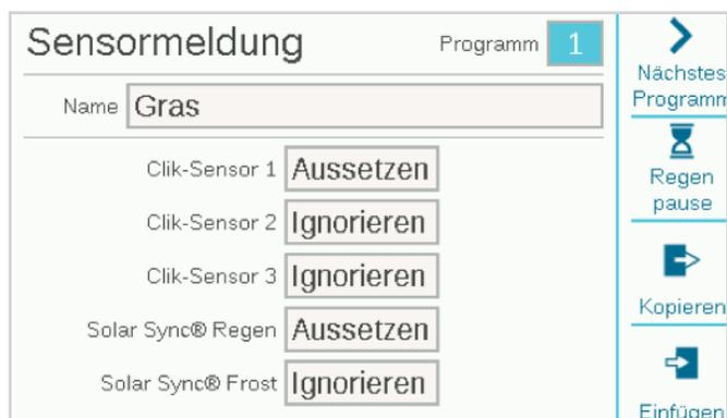
Es gibt drei Standard Clik-Sensor Eingänge auf der Netzteilplatine. Wenn ein Hunter Solar Sync Sensor konfiguriert wurde, gibt es zusätzlich Einstellungen für Solar Sync Regen und Frost.
