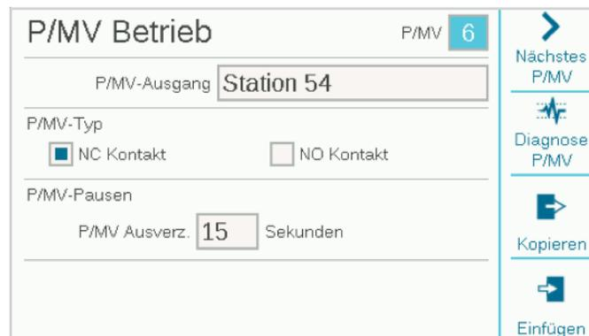
Diese werden dann als „Soft P/MVs“ bezeichnet. Sobald eine Station als P/MV bestimmt wurde, ist dies ihre einzige Funktion und darf nicht in den Berechnungsprogrammen als „reguläre“ Station aufgeführt werden.
