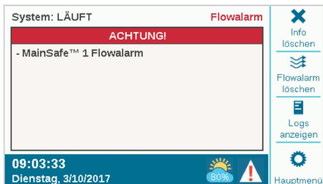
Wenn der tatsächliche Flow die maximale Flow Erlaubnis für die Flowzone überschreitet und für die in der Alarmverzögerung angegeben Zeit fortfährt, sendet die Flowzone einen Alarm und schaltet sich ohne weitere Diagnose ab. Das gleiche trifft auf die MainSafe Zonen zu, falls zutreffend. Das Steuergerät geht davon aus, dass die Überflow Bedingung das Ergebnis einer defekten Hauptleitung über der Stationsebene ist.
